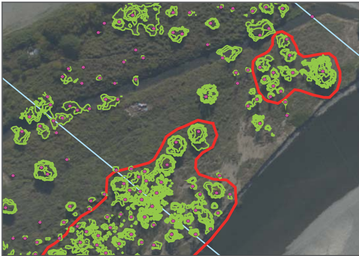
EX.1 LPデータ(表層と地盤の差分)から樹木コンター図を作成した事例
