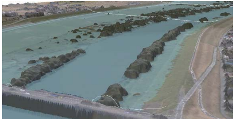
EX.5 LP表層モデルとオルソ画像と合わせて3次元浸水シュミレーションした事例
